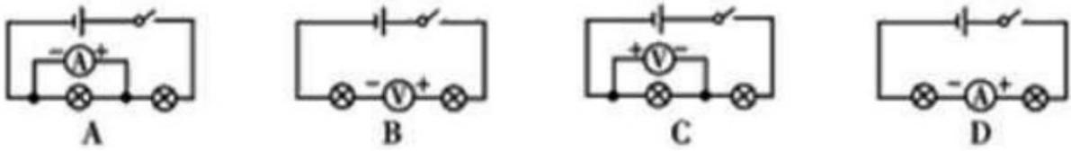
**【分析】**电压表是测量电源电压或用电器两端电压的仪表, 电压表要并联在电路中, 并且电流从正接线柱流入、从负接线柱流出;
