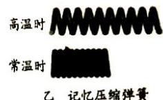
给记忆合金材料通上交替变化的脉冲电流, 使其温度升高。为控制加热快慢, 通常采用改变一个周期内通有电流的时间占总时间的比值的办法来实现。
