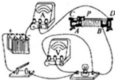
**【分析】** (1) 根据滑片的移动可知接入电路电阻的变化, 根据欧姆定律可知电路中电流的变化和待测电阻两端的电压变化。
